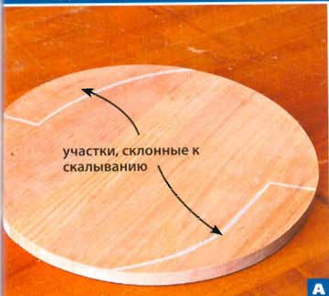
В зонах, где велика вероятность появления сколов, древесные волокна расположены параллельно кромке.
