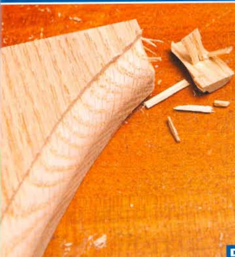
Узкий конец полочного кронштейна откололся при фрезеровании простого скругления.
